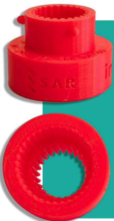
A lo largo del proyecto se fabricaron varios tipos de combinaciones de Muelas con diferentes formas, tamaños, espesores, cantidad y orientación de sus dientes; de acuerdo a los distintos diámetros de las tapas de cierre y formas de envases a utilizar.
